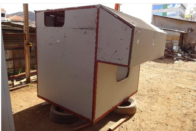
Die einzelnen Teile werden durch eine neue Schweiss-technik verbunden und mit spezieller Versiegelung wasser- undurchlässig abgedichtet.
